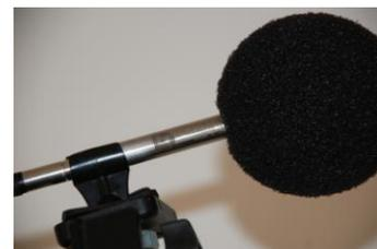
La calibrazione dello strumento è stata effettuata all'inizio ed alla fine di ogni misura; lo scostamento riscontrato tra le due calibrazioni di inizio e fine misura non è mai stato superiore a +/- 0,2 dB: poiché sono considerati accettabili, in base all'art. 2 comma 3 del DM 16/03/98 scostamenti contenuti entro +/- 0,5 dB, le misure sono da ritenersi valide. I certificati di taratura vengono allegati alla presente relazione.
